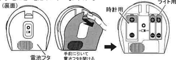
電池フタを手前に引いて開け、上図のように「⑩時計用電池ホルダー」に単2乾電池1本を、「⑪ライト用電池ホルダー」に単3乾電池2本を、電池のプラス(+) マイナス(-)の方向を正しく入れてください。絶縁シートなどが付いている場合は取り外してから乾電池をセットしてください。乾電池をセットしたら「電池フタ」を閉めてください。
