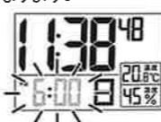
アラーム時刻を合わせる状態 （現在設定されているアラーム時刻が点滅）
